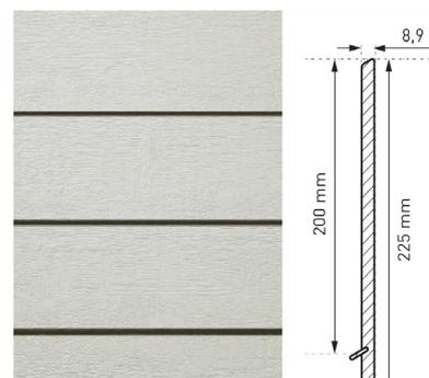
Lame simple pour une pose par recouvrement horizontale ou diagonale, avec languette arrière pour maintien de la partie basse.
