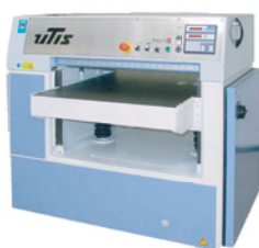
Raboteuse utis - largeur : 710 mm
